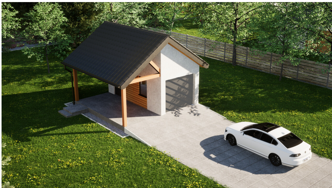
Garaz ERDOL G1W - Wersja lewa - Układ kalenicy prostopadły z dachem dwuspadowym o kącie nachylenia 35 stopni - Bez bramy - Antracyt
