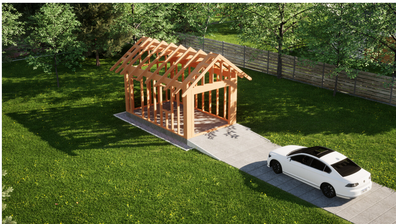
Widok konstrukcji: Garaż ERDOL G1 - Wersja lewa - Układ kalenicy prostopadły z dachem dwuspadowym o kącie nachylenia 35 stopni
