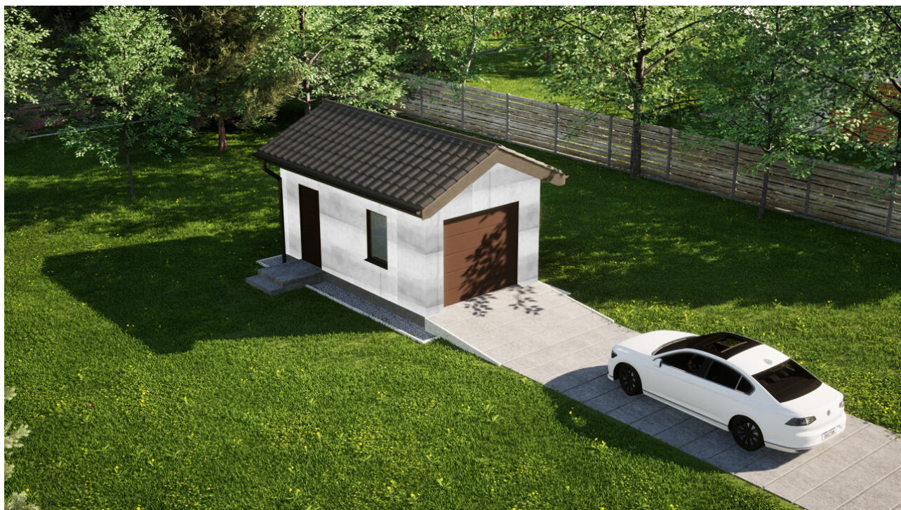
Garaz ERDOL G1 - Wersja lewa - Układ kalenicy prostopadły z dachem dwuspadowym o kącie nachylenia 25 stopni - Brama segmentowa z napędem IO, sterowana pilotem - UniPro WISNIEWSKI - Orzech
