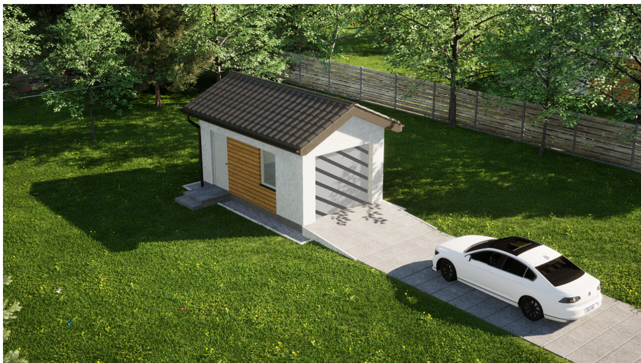
Garaz ERDOL G1 - Wersja lewa - Układ kalenicy prostokątny z dachem dwuspadowym o kącie nachylenia 25 stopni - Bez bramy - Białe
